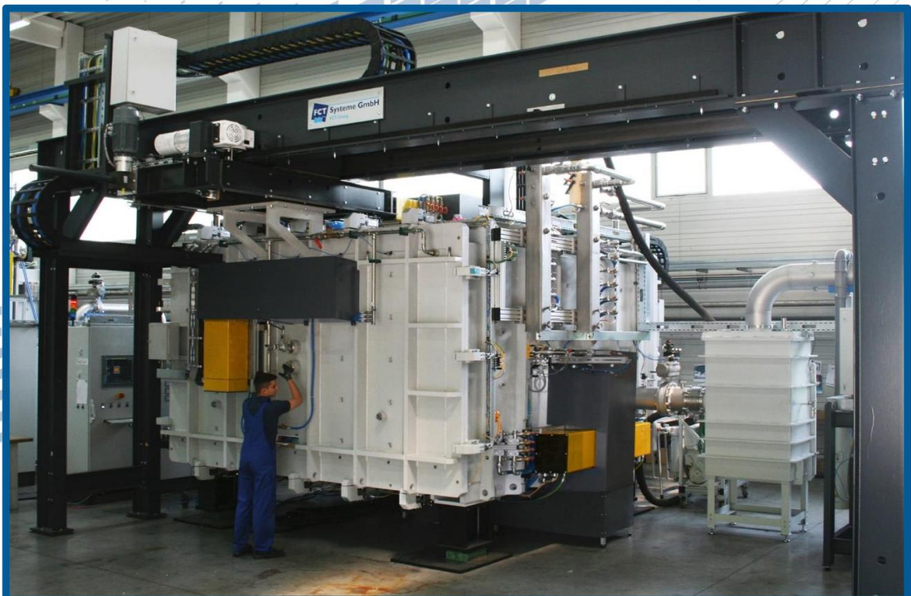
**Bild** Hochtemperatur-Vakuumsinterofen für die effiziente Herstellung großformatiger Bauteile
