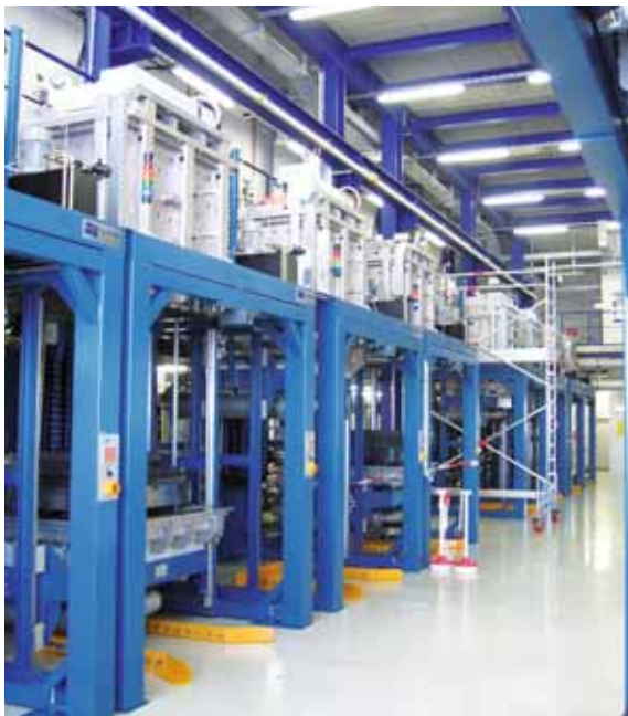
Bild 1 Produktionshalle mit über 20 identischen FCT-Kammeröfen
