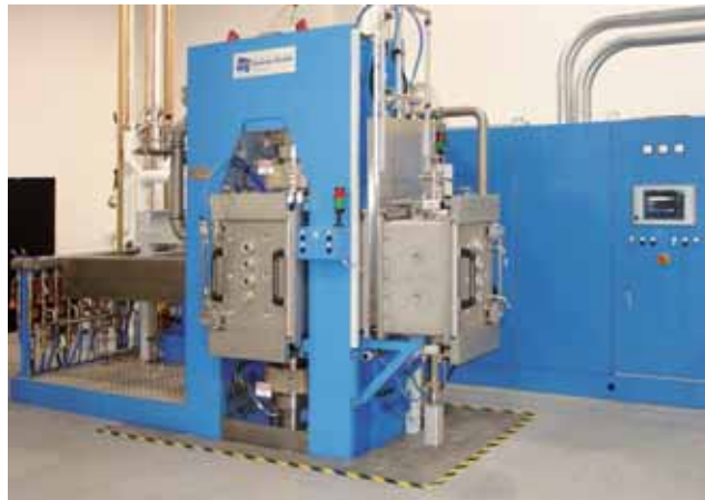
Bild 3 Semi-kontinuierlich arbeitende FAST/SPS-Produktionsanlage Typ HP D 250/C
