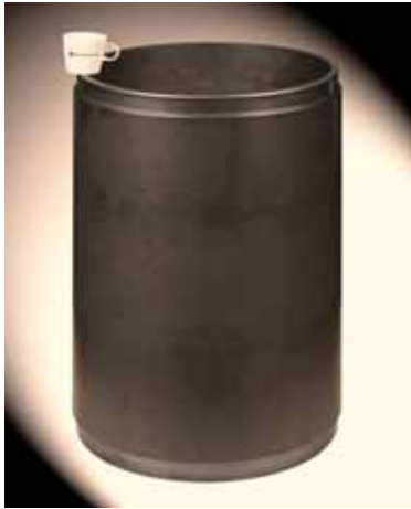
Bild 2 Eines der größten monolithischen Bauteile aus SiC, durch präzise Ofentechnologie mit hoher Form- und Maßgenauigkeit gesintert
