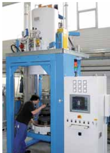
Bild 8 Drucksinterofen für bis zu 100 bar Gasdruck bei maximal 2200 °C
