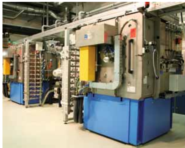
Bild 4 Twin-Ofen für das Pyrolysieren und Silizieren von C/SiC-Bauteilen
