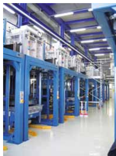
Bild 1 Blick in eine Produktionshalle mit einer Vielzahl identischer, im „quasi-kontinuierlichen“ Betrieb arbeitenden Hochtemperatur-Sinteröfen
