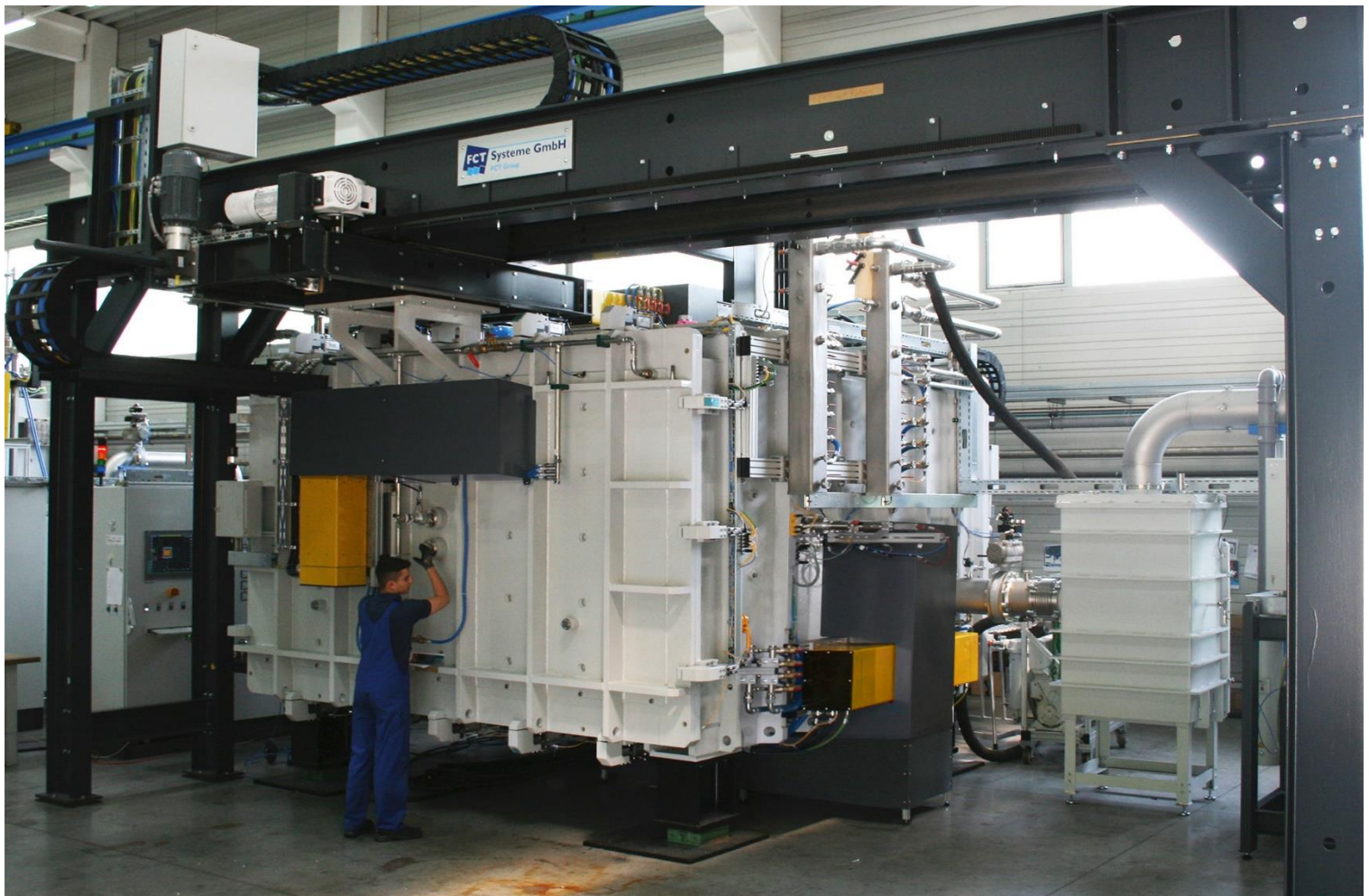
Bild Hochtemperatur-Vakuumsinterofen für die effiziente Herstellung großformatiger Bauteile Fig. High-temperature vacuum sintering furnace for efficient production of large-size components.
